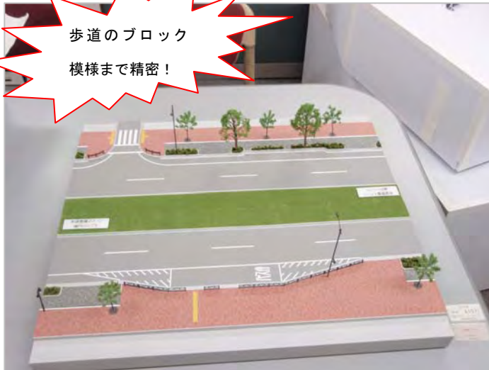
写真-2 歩道の詳細模型 (S=1/75)
